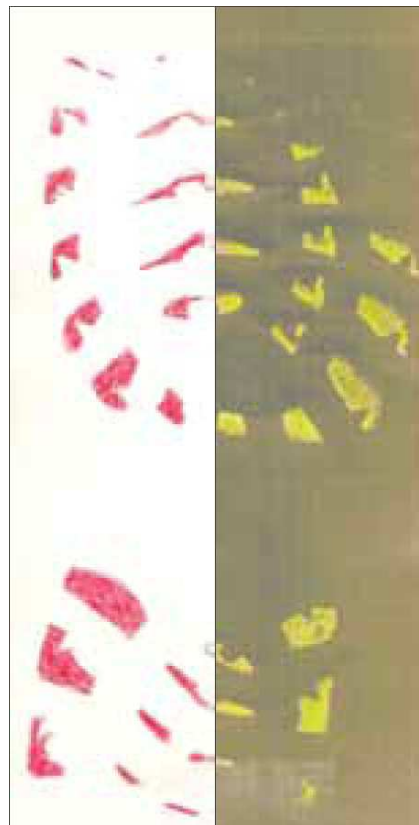
Le côté gauche de cette image montre la coloration rouge visible du LV503. Elle entre en fluorescence une fois éclairée par du 520-560nm (droite)
