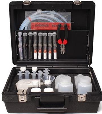
**La mallette AEC200** assistera l'enquêteur dans le prélèvement de liquides sur une scène d'incendie avec le moins de contamination possible. Chaque bouteille de prélèvement en verre est à usage unique et équipée d'un capuchon résistant aux hydrocarbures.
